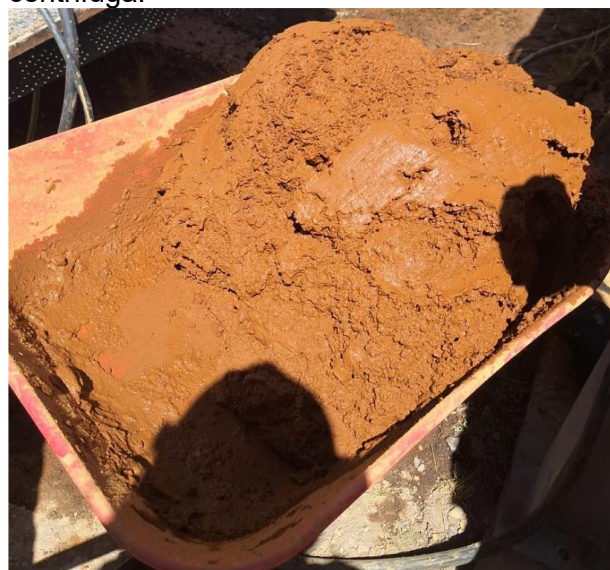
Figura 14: Lodos deshidratado mediante tecnología centrífuga.
